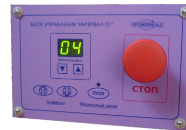
Панель управления тестомесильной машиной - представляет собой программируемый цифровой таймер с отображением текущего времени работы и кнопками управления механизмами тестомеса. С задней стороны панели установлен пыленепроницаемый корпус
