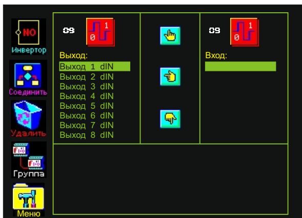
Рис. 27. Выходы функционального блока "Дискретный ввод"
