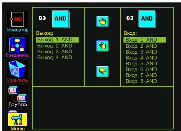
Рис. 61. Входы и выходы блока “Логическое И” на экране контроллера
