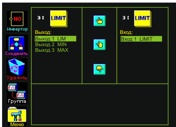
Рис. 119. Входы и выходы функционального блока “Ограничение” на экране контроллера
