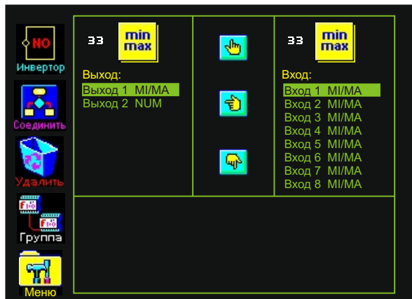
Рис. 115. Входы и выходы функционального блока “Минимум-Максимум” на экране контроллера
