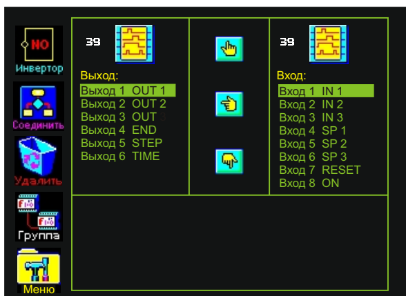
Рис. 155. Входы и выходы функционального блока "Программа" на экране контроллера
