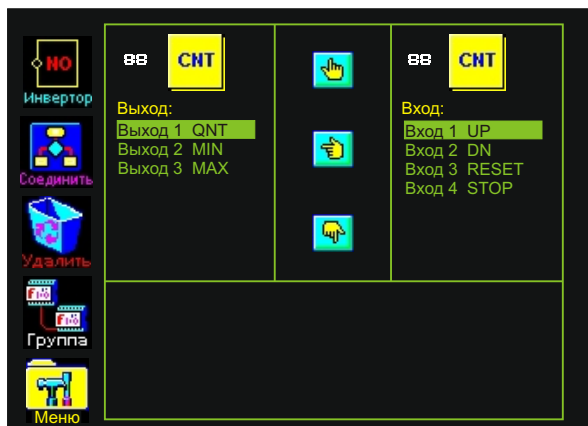
Рис. 132. Входы и выходы функционального блока “Счетчик” на экране контроллера
