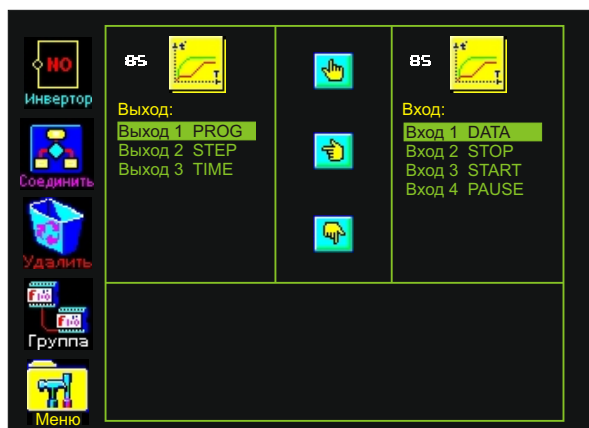
Рис. 95. Входы и выходы функционального блока “Программатор” на экране контроллера
