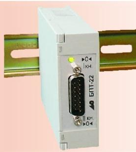
**ПРЕДНАЗНАЧЕН** для преобразования сигнала термопар типа TXK(L), TXA(K), TPP(S), TPP(B), TBP(A), TJK(J), TXKn(E) в выходной унифицированный сигнал постоянного тока.
