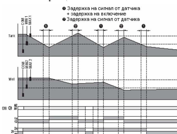
Эта функция включает заполнение бака, используя насос опустошения резервуара. Электроды MAX1 и MIN1 используются для бака, а электроды MAX2 и MIN2 устанавливаются в резервуаре.
